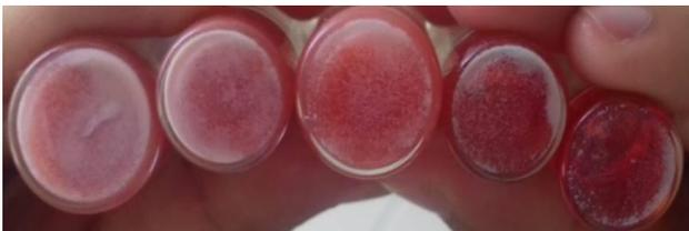
**Figura 3.** Nanoestructuras de ZnO precipitadas en lubricante automotriz.
